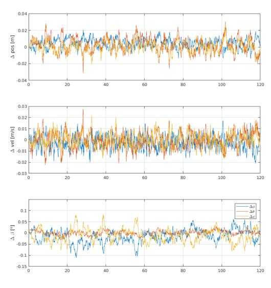
Concluimos que la navegación integrada con un sensor visual permite estabilizar la estimación de actitud, y reduce la divergencia en la estimación de posición.
